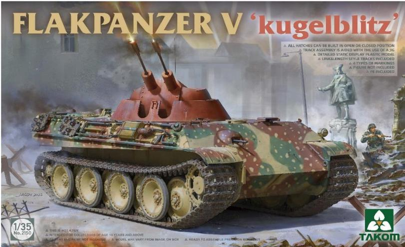
クーゲルブリッツは第二次世界大戦中のドイツ軍の開発した球形の密閉型砲塔を搭載した対空戦車です。搭載された機関砲はラインメタル MK103が2門で、砲塔は装甲で覆われていました。本車は1944年4月から開発が開始され、同年9月に量産が始まる予定でしたが、車台として用いるはずだったIV号戦車またはIII/IV号自走砲車台の生産中止が決まり、7両分の車体と少数の砲塔を製造した段階で計画のみに終わりました。キットは計画のみされた、パンター車台を使用したクーゲルブリッツを再現しています。4種マーキング付き。
